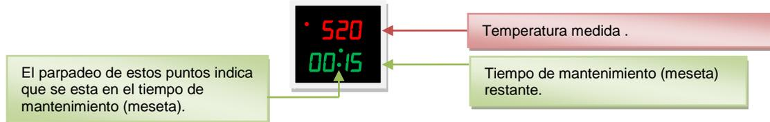
En el *display* inferior se muestra el tiempo de mantenimiento que falta para finalizar la cocción, en el formato *Horas:Minutos* o *Minutos:Segundos*.
