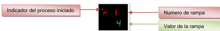
**Nota 5:** si el proceso se ha iniciado y estamos en una meseta, presionando la tecla **F**, observaremos en el *display* superior el número de meseta y en el *display* inferior el tiempo cargado.
