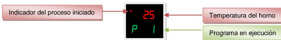
**Nota 4:** si el proceso se ha iniciado y se presiona la tecla **F**, el *display* inferior nos indica el valor de la rampa que se está ejecutando.
