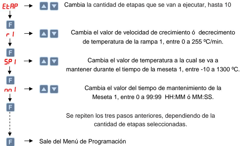
**Nota1:** Si se mantiene presionada una de las teclas ▲ ▼, luego de un momento el valor comenzará a modificarse rápidamente. Si no se presiona ninguna tecla, pasado algunos segundos sale del Modo Programación, guardando los cambios y vuelve al Modo de Control.
