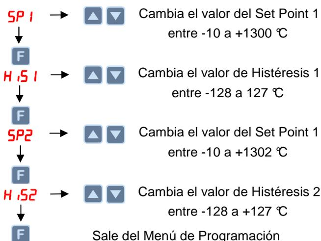
**Nota1:** Si se mantiene presionada una de las teclas ▲ ▼, luego de un momento el valor comenzara a modificarse rápidamente. Si no se presiona ninguna tecla, pasado algunos segundos sale del Modo Programación, guardando los cambios y volviendo al Modo de Control.
